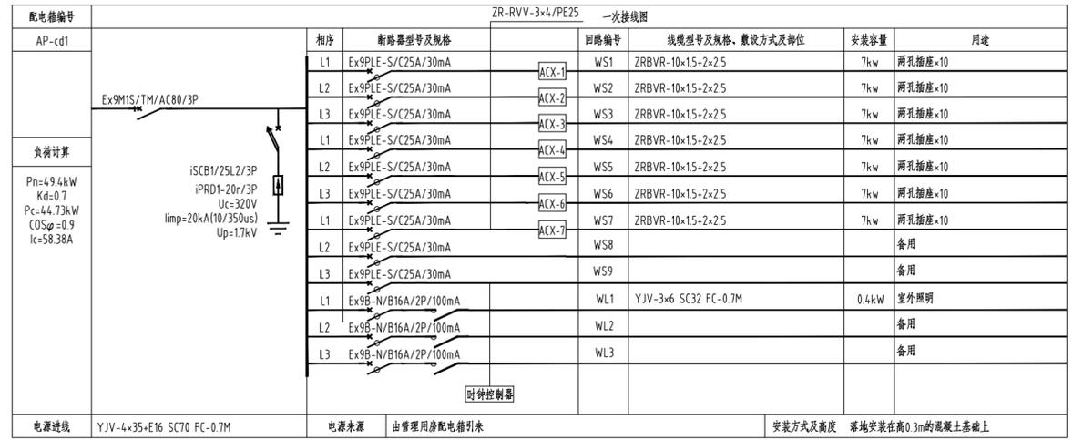
自行车停车棚非机动车充电设备配电箱AP-cd1 系统图
